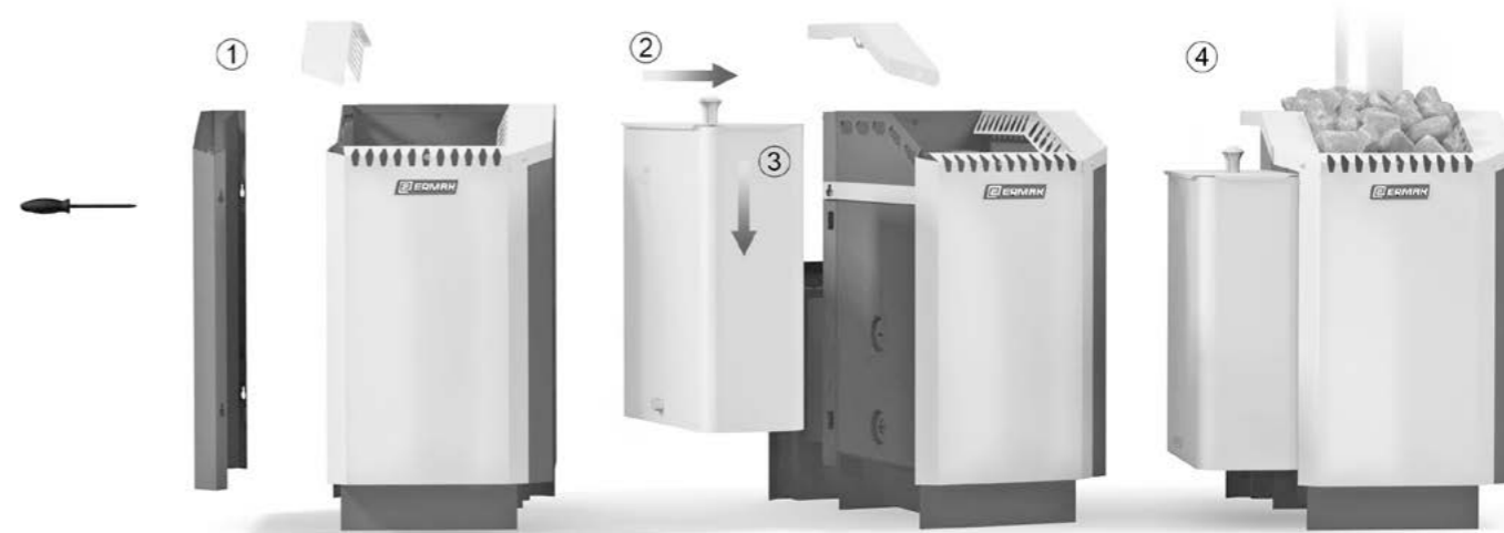
Рисунок - 9. Последовательность установки бака для нагрева воды
